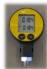
Anzeige Druck von bar umgerechnet in kundenspezifische Einheit
